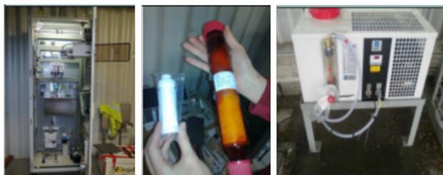
Photo 4 : Préleveur de dioxine : Armoire (gauche), cartouche (milieu) et clim (droite)
