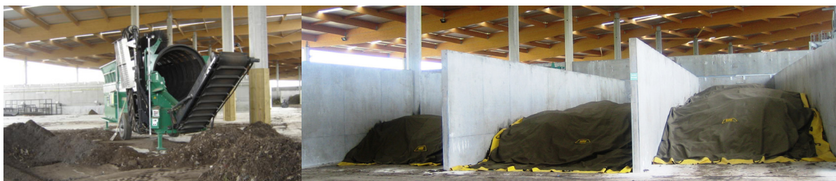
Photo 9 : Cribleur (à gauche) et Box de fermentation (à droite) de l'Unité de Valorisation Agronomique
