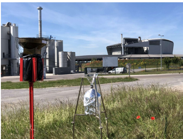
Photo 5 : Jauge pour le prélèvement des retombées atmosphériques totales
