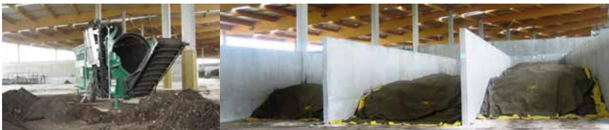
Photo 13 : Cribleur (à gauche) et Box de fermentation (à droite) de l'Unité de Valorisation Agronomique
